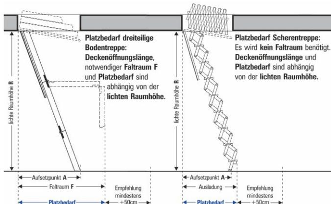
Der genaue Platzbedarf (= Faltraum bei dreiteiligen Bodentreppen bzw. Ausladung bei Scherentreppe) ist abhängig von Raumhöhe, Treppentyp, Zusatzausstattung. Wir empfehlen zusätzlich mindestens 50 cm mehr Platz zum Bedienen und Begehen der Treppe. Maße immer online prüfen unter [www.massbox.de](http://www.massbox.de)
