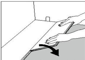
3. Drücken Sie das erste Element der zweiten Reihe mit der Federseite in einem Winkel gegen die Nutseite der ersten Reihe. Pressen Sie die Dielle nach vorne und legen Sie sie gleichzeitig an den Boden an.
