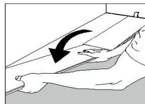
4. Legen Sie die Stirnseite des nächsten Elements im Winkel gegen die vorher verlegte Dielle an und legen Sie sie dann auf den Boden. Dabei muss die Längsseite auf die Verriegelungsseite der bereits verlegten Reihe gelegt werden.
