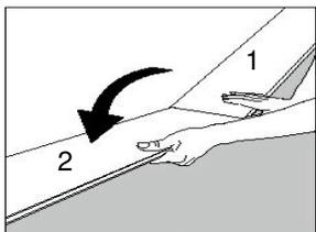
2. Drücken Sie die nächste Dielle im Winkel an die erste Dielle und legen Sie sie dann flach auf den Boden. Verfahren Sie auf die gleiche Weise mit der gesamten ersten Reihe. Schneiden Sie die letzte Dielle der ersten Reihe unter Berücksichtigung des Wandabstandes zu. Beginnen Sie die nächste Reihe mit dem Verschnittstück der ersten. Achten Sie darauf, dass der Längensversatz der Kopfstöße mindestens 30 cm beträgt.
