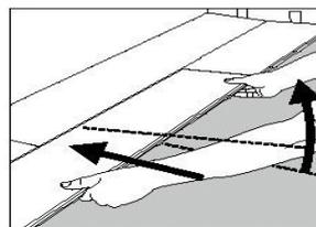
5. Heben Sie dann die Dielle (zusammen mit der vorher gelegten Dielle der gleichen Reihe) etwa 30 mm an der Vorderkante an und drücken sie in die Nut der erlegten Reihe. Wenn die Längskanten aufeinander stoßen, legen Sie die Dielle auf den Boden. Richten Sie die verlegten Reihen mit einem Wandabstand von 10 mm aus. Fahren Sie mit der Verlegung in der beschriebenen Weise bis zur gegenüberliegenden Wand fort.
