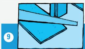
Feste Bauteile wie Türzargen müssen gekürzt werden, damit der **Samoa HYDROTEC-Fertigfußboden** darunter liegen kann. Er darf nicht anstoßen. Vor der Kürzung der Türzarge muß geprüft werden, dass die Türzarge dauerhaft befestigt ist. Ein Absacken der Türzarge könnte die Bewegungsfreiheit des **Samoa HYDROTEC-Fertigfußboden** beeinträchtigen.
