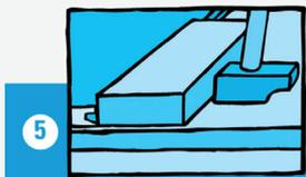
Zum Zusammenfügen der Kurzkante schlagen Sie diese ausschließlich mit der **KWG uniclic Schlagleiste** an der Nutseite vorsichtig ineinander. Schlagen Sie nie die Federseite, da diese sonst beschädigt werden kann. Bei zu starkem Zusammenklopfen kann sich die Korkauflage im Kantenbereich hochdrücken. Für die letzte Diele in einer Reihe benötigen Sie ein Zugeisen zum Zusammenfügen. Bei unsachgemäßer Verlegung können Schäden an den Verbindungsprofilen entstehen.
