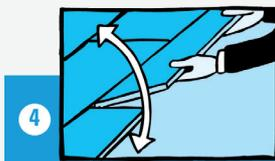
Der **Samoa HYDROTEC-Fertigfußboden** wird üblicherweise nicht geleimt, sondern trocken verlegt. Dabei werden die einzelnen Dielen mit der Feder der Langkante in die Nut der davor liegenden Diele in einem Winkel von 20-30° eingedreht, indem man die Diele auf und ab bewegt.
