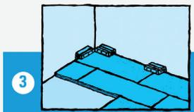
Bei den Dielen der ersten Reihe wird die Feder der Langkante mit einer geeigneten Säge abgeschnitten, so dass die Schnittkante zur Wand zeigt. Die folgenden Dielenreihen sollen mind. 1/3 versetzt verlegt werden. Optimal ist die Verlegung im Halbverband.
