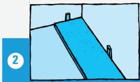
Eine Dehnfuge von mind. 10 mm zwischen dem **Samoa HYDROTEC-Fertigfußboden** und der Wand sowie allen festen Bauteilen, wie Heizungsrohre, Türzargen usw., muss ein gehalten werden. Raumlänge bis 10m = 10mm Dehnfuge; bei einer Raumlänge ab 10m je weiteren Meter 1mm Dehnfuge zusätzlich einhalten (maximale Raumgröße 12m Länge und 8m Breite)
