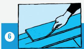
Die letzte Dielenreihe wird in die richtige Breite gesägt. Dabei ist auf die Dehnungsfuge zu achten! Danach wird die Dehnungsfuge mit einer Fußleiste abgedeckt. Sie darf allerdings nicht zu dicht auf dem **Samoa HYDROTEC-Fertigfußboden** liegen, um die Bewegungsfreiheit des Bodens nicht zu beeinträchtigen.
