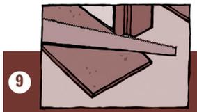
Feste Bauteile wie Türzargen müssen gekürzt werden, damit der **antigua-Fertigfußboden** darunter liegen kann. Es darf nicht anstoßen. Vor der Kürzung der Türzarge muß geprüft werden, dass die Türzarge dauerhaft befestigt ist. Ein Absacken der Türzarge könnte die Bewegungsfreiheit des **antigua-Fertigfußboden** beeinträchtigen.
