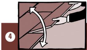
Der **antigua-Fertigfußboden** wird üblicherweise nicht geleimt, sondern trocken verlegt. Dabei werden die einzelnen Dielen mit der Feder der Langkante in die Nut der davor liegenden Diele in einem Winkel von 20-30° eingedreht, indem man die Diele auf und ab bewegt.
