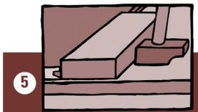
Zum Zusammenfügen der Kurzkante schlagen Sie diese mit der **KWG Schlagleiste** an der Nutseite vorsichtig ineinander. Schlagen Sie nie die Federseite da diese sonst beschädigt werden kann. Bei zu starkem Zusammenklopfen kann sich die Vinylauflage im Kantenbereich hochdrücken. Für die letzte Diele in einer Reihe benötigen Sie ein Zugeisen zum Zusammenfügen.
