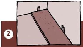
Eine Dehnfuge von mind. 10 mm zwischen dem **antigua-Fertigfußboden** und der Wand sowie allen festen Bauteilen wie Heizungsrohre, Türzargen usw., muss eingehalten werden. Raumlänge bis 10m = 10mm Dehnfuge; bei einer Raumlänge ab 10m je weiteren Meter 1mm Dehnfuge zusätzlich einhalten (maximale Raumgröße 15m Länge und 10m Breite).
