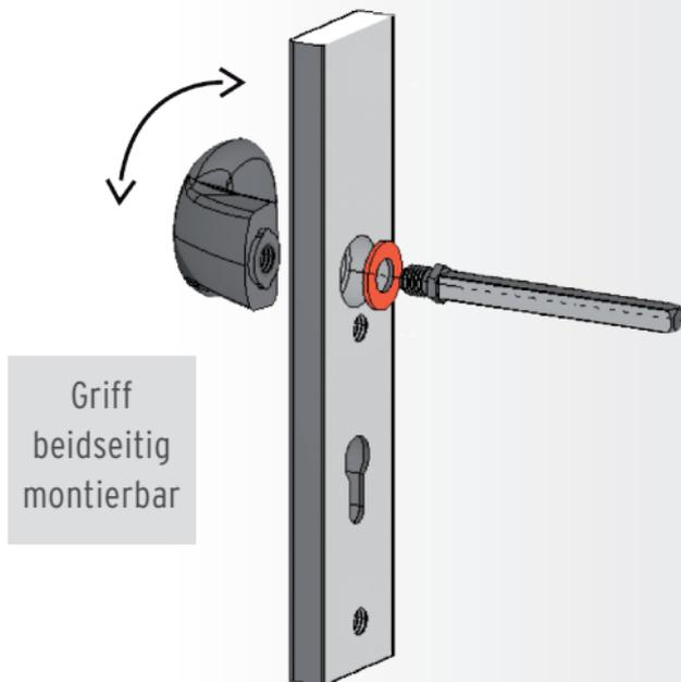
Bei der Wechselgarnitur wird der Griff mit Hilfe des RW-Stiftes auf das Außenschild montiert.
