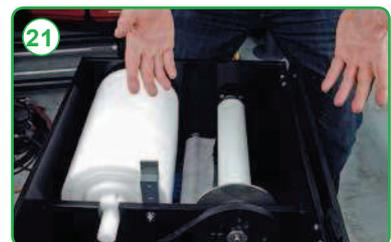
... und setzen Sie die Einweghaspel ein. Filterpapier einsetzen VI.
