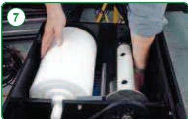
7 Drehen Sie nun die Trommel von Hand in der Richtung, dass sich das neue Papier einmal um die Trommel wickelt.
