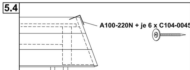
**!** Legen Sie erst die Dachplatten aus, bevor Sie diese befestigen. Die Anzahl der Überlappungen in der Breite kann unterschiedlich sein und richtet sich nach der Carportbreite. Die Dachplatten müssen teilweise bauseits geschnitten werden.
