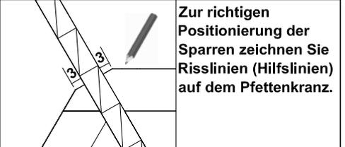
Zur richtigen Positionierung der Sparren zeichnen Sie Risslinien (Hilfslinien) auf dem Pfettenkranz.
