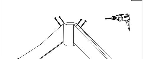
Montieren Sie am Boden zwei gegenüberliegende Sparren.
