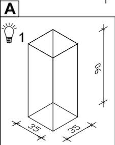
Fundamente gemäß Statik Beton C25/30
