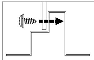
Die Wandpaneele immer am Bodenrahmen mit Schrauben wie oben angezeigt befestigen.
