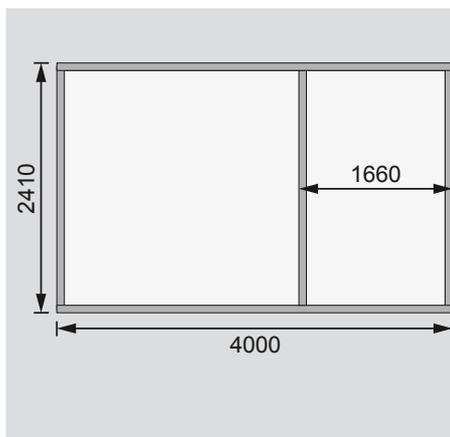
Fundamentplan mit Boden (in mm)
