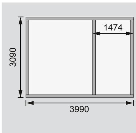
Fundamentplan mit Boden (in mm)
