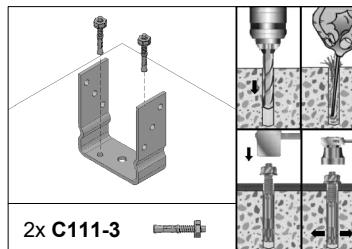
**DE** Positionieren Sie die Anker laut Plan und fixieren Sie diese nach Kontrolle mit den Schwerlastdübel.
