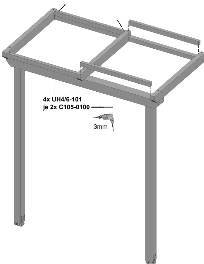
**DE Dachlatte vorne bündig mit dem lotrechten Abschnitt des Sparrenkopfes und hinten bündig mit der Vorderkante Wandpfette.**
