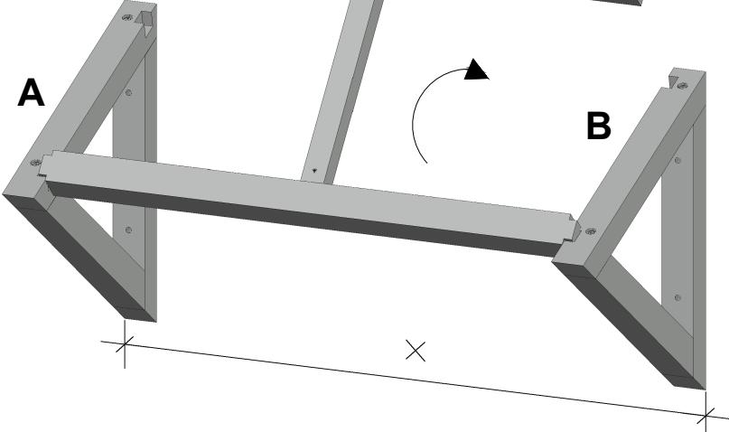
**DE** Übertragen Sie das Abstandsmaß an die Hauswand und nutzen Sie die Schablone um die Bohrlöcher zu markieren.
