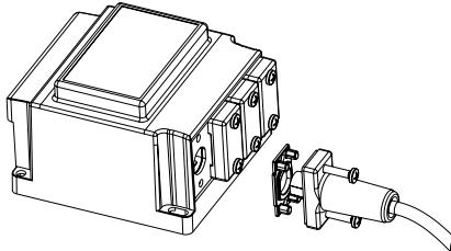
Riadte sa návodom na použitie pre svetlomet a súpravu kálov. Pozor: Inštalovaný výkon žiaroviek nesmie prekročiť výkon transformátora podľa typového štítku.
