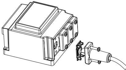
Říďte se návodem k použití pro světlomet a sadu kabelů. Pozor: Instalovaný výkon žárovek nesmí překročit výkon transformátoru podle typového štítku.
