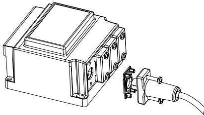
Дотримуйтесь інструкцій з використання прожектора і кабельної арматури. Увага! Встановлена потужність лампи не повинна перевищувати потужність трансформатора (див. інформаційну таблицю).
