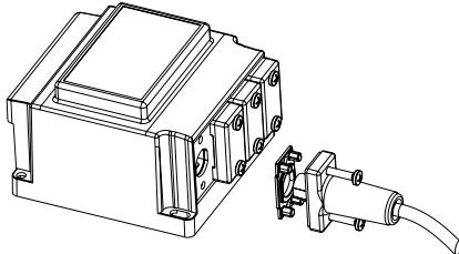
Beakta bruksanvisningarna till strålkastaren och kabelsetet. Obs! Den installerade lampeffekten får inte överskrida transformatorns effekt enl. uppgifterna som anges på typskylten.
