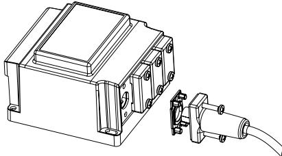
Følg brugsvejledningerne for projektøren og kabelsættet. OBS: Den installerede lampeeffekt må ikke overskride transformatorens effekt i henhold til typeskiltet.
