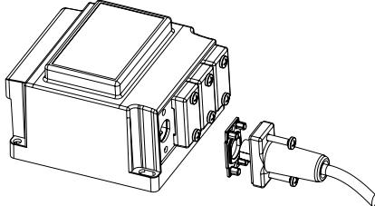
Upoštevajte navodila za uporabo žarometa in kabelske garniture. Pozor: Moč vgrajene žarnice ne sme presegati moči transformatorja v skladu s tipsko ploščico.
