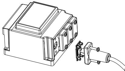
Respecter les modes d'emploi du projecteur et du jeu de prise jack. Attention : la puissance de la lampe installée ne doit pas dépasser la puissance du transformateur conformément à la plaque signalétique.
