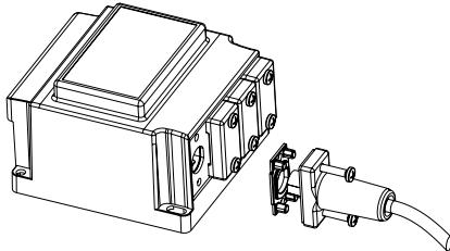
Соблюдайте указания по использованию прожектора и кабельной гарнитуры. Внимание: Установленная мощность ламп не должна превышать мощность трансформатора согласно фирменной табличке.
