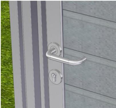
Stecken Sie die Drückergarnitur inkl. Kunststoffrosetten beidseitig in die dafür vorgesehenen Öffnungen, dazwischenliegend den Vierkantstift, und verschrauben mit jeweils 3 Senkkopfschrauben 3,5 x 16 mm (pro Seite) durch die vorhandenen Bohrungen (Bohrungen in den Kunststoffrosetten und im Aluminiumrahmen müssen übereinstimmen).
