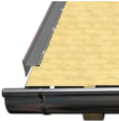
Verschraubung am Profilstoß, dann alle 50 cm.
