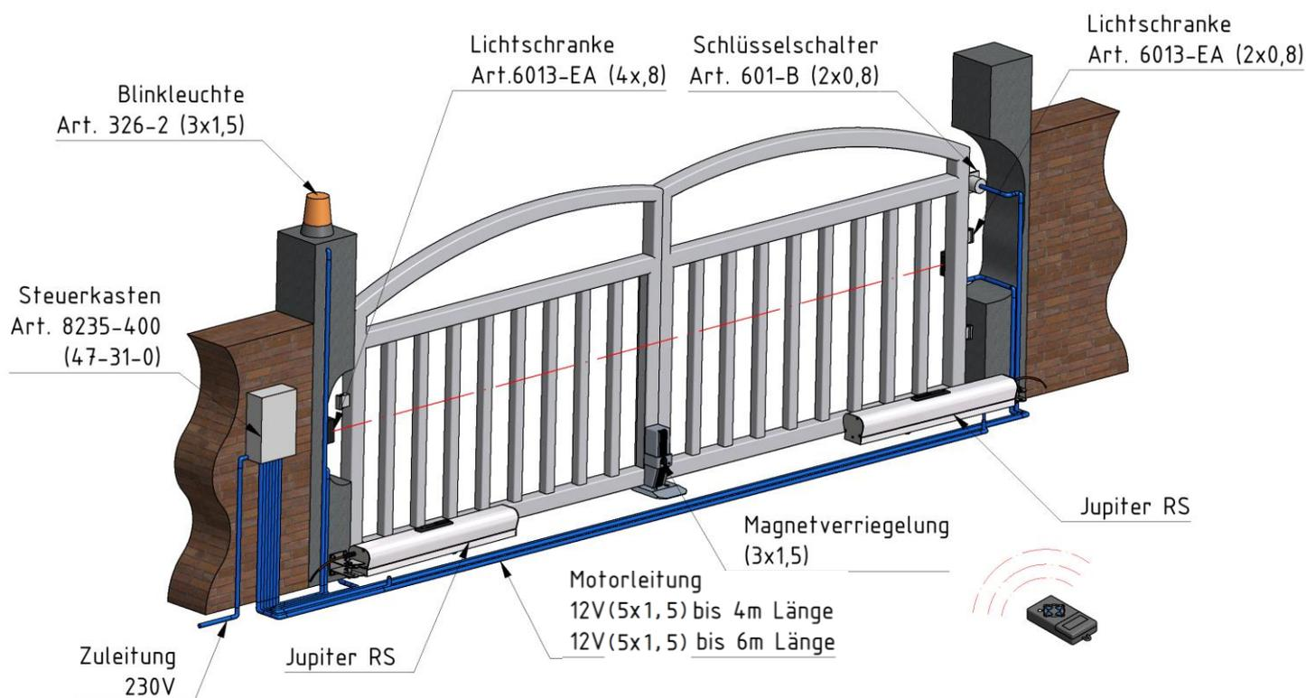
Die Antriebe haben ein 90 cm langes Antriebskabel sollten diese nicht ausreichen verwenden Sie bitte eine wasserdichte Zwischendose mit 6 Klemmen. Dargestellt ist ein zweiflügeliges Tor.
