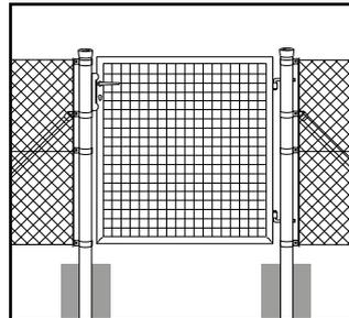
Um die Stabilität der Toranlage zu erhöhen, empfiehlt es sich, an jedem Torpfosten in Richtung des Geflechtes eine Strebe zu setzen.
