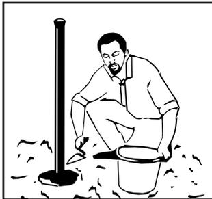
Erstellen Sie die Fundamentlöcher (ca. 30 x 30 cm im Quadrat, Tiefe je nach Torpfostenlänge, frostsicher bei ca. 80 cm). Beachten Sie, daß der Torflügel am Boden noch genug Spielraum zum Öffnen und Schließen des Tores hat. Torbreiten sind immer von Mitte bis Mitte Pfosten angegeben, d.h. die tatsächliche Torbreite ist um eine Pfostenbreite größer.
