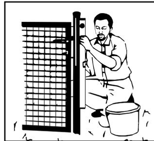
An dem Schließpfosten bringen Sie zunächst den Toranschlag an und betonieren ihn ebenfalls ein.
