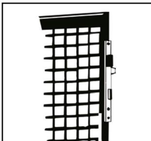
Jetzt können Sie das Rohrrahmenschloß, die Drücker und den Buntbarteinsatz einsetzen. Der Buntbarteinsatz kann auch durch einen Profilzylinder ersetzt werden.
