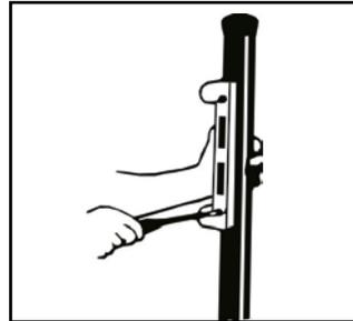
**TIPP:** Schieben Sie den Buntbarteinsatz komplett mit dem Schlüssel zusammen in die dafür vorgesehene Öffnung. Drehen Sie den Schlüssel um 180°, so daß der Schlüsselbart in den Schließmechanismus greift aber noch nicht ganz zugeschlossen ist. Jetzt können Sie den Buntbarteinsatz fixieren. Das lästige Justieren des Buntbarteinsatzes entfällt somit.
