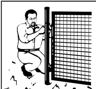
Wenn der Hängepfosten einbetoniert ist und der Beton abgebunden hat, können Sie den Torflügel anbringen und durch Verstellen der Klobenmuttern ausrichten.
