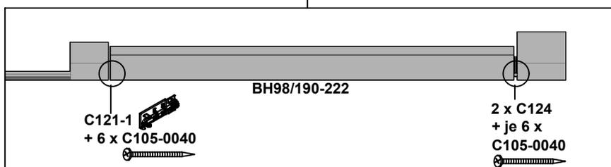
Die Höhe der einzelnen Profildreher kann variieren. Achten Sie daher beim Montieren auf gleiche Gesamthöhen der Wände.
