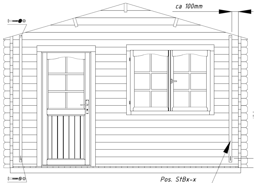
Installatie van de stormankers:
