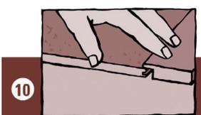
Übergänge zwischen dem **antigua-Fertigfußboden** und anderen Bodenbelägen sowie zwei aneinanderliegenden Räumen müssen generell mit einem Parkettprofilsystem abgedeckt werden.
