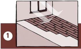
Es ist zu empfehlen an einer geraden Wand längs zum Lichteinfall von links nach rechts zu beginnen. Eine Dampfsperre ist bei allen mineralischen Untergründen unerlässlich. Legen Sie dazu eine mindestens 0,2 mm starke PE-Folie unter den **antigua-Fertigfußboden**, wobei die Stoßkanten ca. 20 cm überlappen und abgeklebt werden müssen. An den Wänden ist die Folie ca. 3 cm hochzuziehen. Wir empfehlen Ihnen die Übergänge mit einem Klebeband abzukleben.
