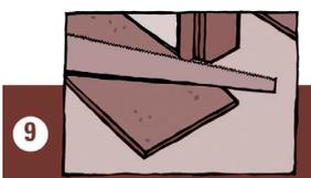
Feste Bauteile wie Türzargen müssen gekürzt werden, damit das **antigua-Fertigfußboden** darunter liegen kann. Es darf nicht anstoßen. Vor der Kürzung der Türzarge muß geprüft werden, dass die Türzarge dauerhaft befestigt ist. Ein Absacken der Türzarge könnte die Bewegungsfreiheit des **antigua-Fertigfußboden** beeinträchtigen.
