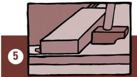
Zum Zusammenfügen der Kurzkante schlagen Sie diese mit der **KWG Schlagleiste** an der Nutseite vorsichtig ineinander. Schlagen Sie nie die Federseite da diese sonst beschädigt werden kann. Bei zu starkem Zusammenklopfen kann sich die Vinylauflage im Kantenbereich hochdrücken. Für die letzte Diele in einer Reihe benötigen Sie ein Zugschlageisen zum Zusammenfügen.
