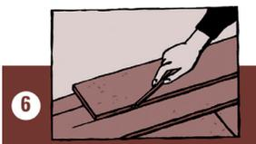
Die letzte Dielenreihe wird in die richtige Breite gesägt. Dabei ist auf die Dehnungsfuge zu achten! Danach wird die Dehnungsfuge mit einer Fußleiste abgedeckt. Sie darf allerdings nicht zu dicht auf dem **antigua-Fertigfußboden** liegen, um die Bewegungsfreiheit des Bodens nicht zu beeinträchtigen.
