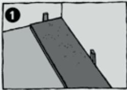
Eine Dehnfuge von mind. 10 mm zwischen dem **SAMOA-FERTIGFUßBODEN** und der Wand sowie allen festen Bauteilen wie Heizungsrohre, Türzargen usw., muss eingehalten werden. Bei großen Räumen (ab 8 m Breite) muss die Dehnfuge mind. 1,5 mm pro Meter max. Raumbreite betragen (z. B. 10 m max. Raumbreite = 15 mm Dehnfuge). Die Bodenfläche von 80 m<sup>2</sup> in einer Fläche sollte nicht überschritten werden.
