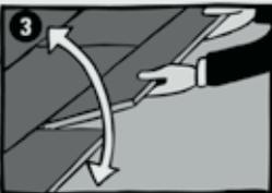
**SAMOA-FERTIGFUßBODEN** wird üblicherweise nicht geleimt, sondern trocken verlegt. Dabei werden die einzelnen Dielen mit der Feder der Langkante in die Nut der davor liegenden Diele in einem Winkel von 20-30° eingedreht, indem man die Diele auf und ab bewegt.
