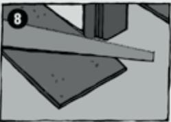
Feste Bauteile wie Türzargen müssen gekürzt werden, damit das **SAMOA-FERTIGFUßBODEN** darunter liegen kann. Es darf nicht anstoßen. Vor der Kürzung der Türzarge muß geprüft werden, dass die Türzarge dauerhaft befestigt ist. Ein Absacken der Türzarge könnte die Bewegungsfreiheit des **SAMOA-FERTIGFUßBODEN** beeinträchtigen.
