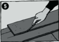
Die letzte Dielenreihe wird in die richtige Breite gesägt. Dabei ist auf die Dehnungsfuge zu achten! Danach wird die Dehnungsfuge mit einer Fußleiste abgedeckt. Sie darf allerdings nicht zu dicht auf dem **SAMOA-FERTIGFUßBODEN** liegen, um die Bewegungsfreiheit des Bodens nicht zu beeinträchtigen.
