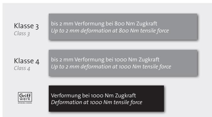
Mehr als nur Alltagstauglichkeit beweisen Griffwerk Drücker im Test der Zugbeanspruchung. Die zusätzliche Qualifikation als Sicherheitsbeschlag im Korrelationschlüssel belegt auch hier die Vorteile der fest drehbaren Lagerung. Einsetzbarkeit von der Familientüre bis für den hochfrequentierten öffentlichen Bereich. Langlebigkeit sichern Ihre Investition.
