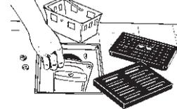
1. Beide Muttern lösen und Rückstauaggregat aus Kellerablauf ausbauen, reinigen, Dichtungen überprüfen und ggf. erneuern.
