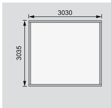
**Fundamentplan mit Boden (in mm)**
