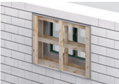
4. Aussteifungen erst nach Erhärten des Mörtels entfernen.
