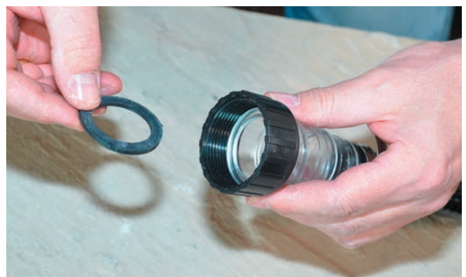
Schlauchanschlüsse nur handfest anschrauben und auf den richtigen Sitz der Dichtung achten!
