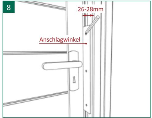
8 | Das Tor mit einem Abstand von ca. 26-28 mm zum Pfosten positionieren, damit sich das Schließblech und der Anschlagwinkel noch montieren lässt. Hierzu das Schließblech mit Anschlagwinkel provisorisch zwischen Pfosten und Torelement halten, um den richtigen Abstand zu bestimmen. Um die Position des Schließbleches festzulegen, müssen bei geschlossenem Tor Markierungen (oben, mitte und unten auf dem Anschlagwinkel) auf den Pfosten angezeichnet werden.
