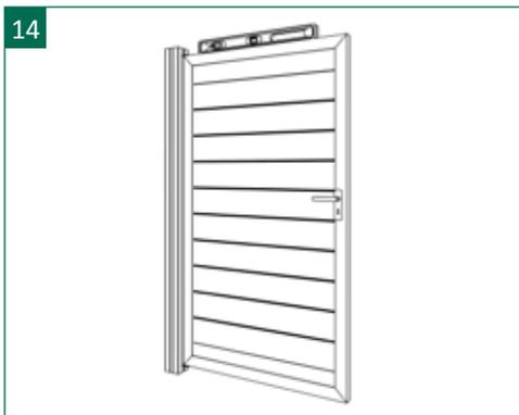
14 | Die waagerechte Ausrichtung des Torelements mit der Wasserwaage kontrollieren, gegebenenfalls korrigieren und mit einer Holzleiste stabilisieren
