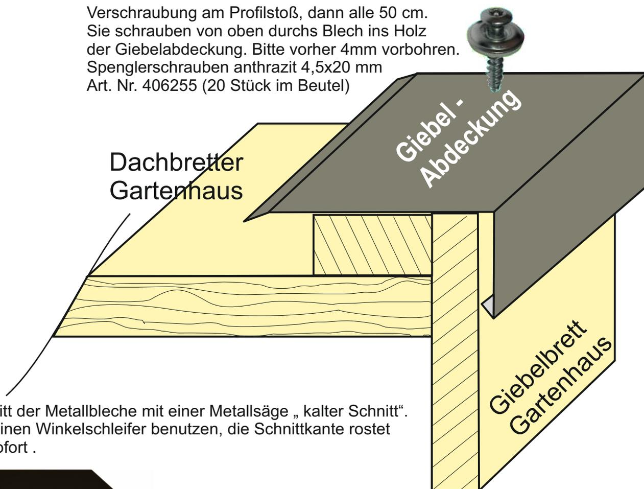
Zuschnitt der Metallbleche mit einer Metallsäge „kalter Schnitt“.
