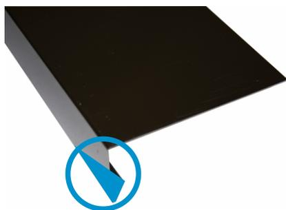
Für den Längensstoß der Bleche ca. 3 - 4 cm Schrägschnitt an der blau markierten Stelle.
