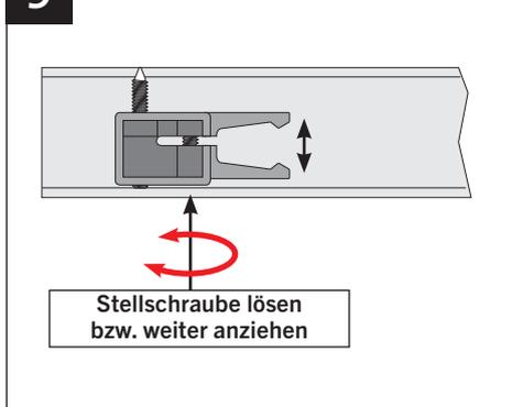
**10** Endposition Tür über Verschieben des Stoppers justieren
