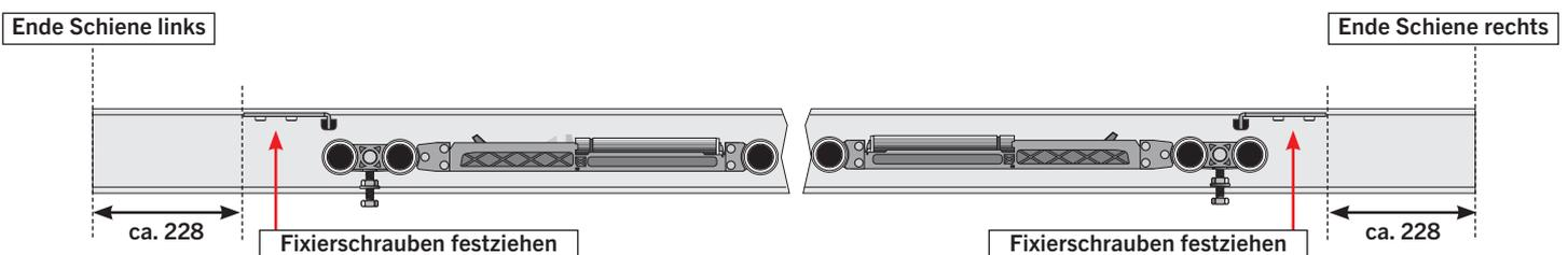
**5** Laufwagen und Stopper links und/oder rechts in Schiene schieben, Stopper montieren / festsetzen
