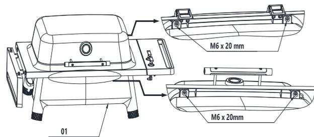
Kippen Sie das Gerät dazu leicht nach hinten und entfernen Sie beide Schrauben M6 x 20 mm. Wiederholen Sie den Vorgang mit der Vorderseite und halten Sie die Einzelteile dabei fest, damit diese nicht herunterfallen. Bewahren Sie die Schrauben und Federscheiben zum späteren Gebrauch auf. Ablösbare Aufkleber an der Vorder- und Rückseite kennzeichnen die Positionen dieser Schrauben. Entfernen Sie das Grillgehäuse samt Garhaube vom Unterbauoberteil und stellen Sie es auf dem Boden ab.
