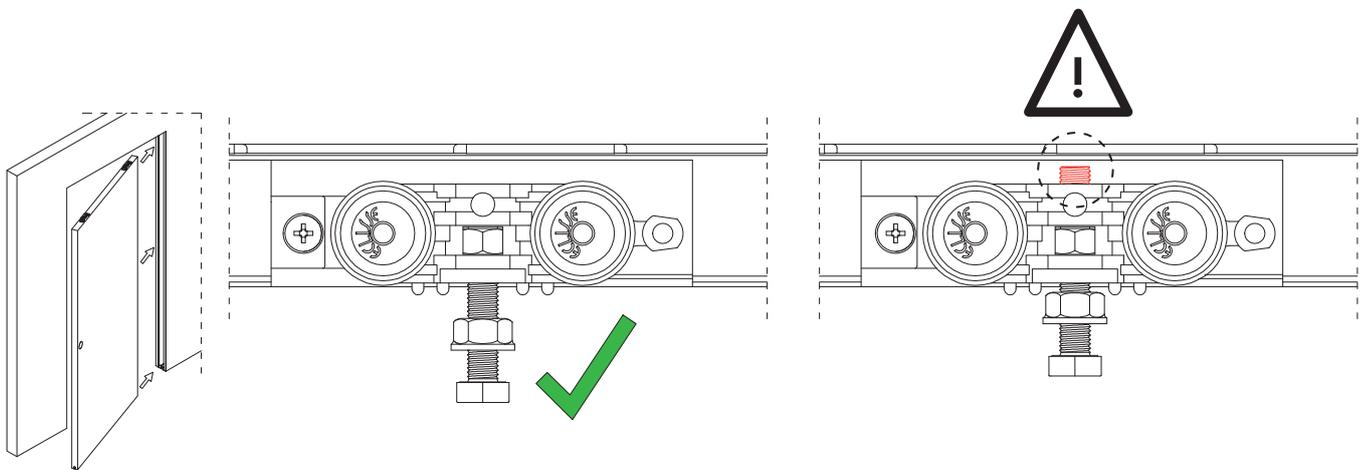
**6 Einzelflügel und Doppelflügel, Bremse hinten:** Schieben Sie das Türblatt soweit in die geöffnete Position, bis Auslöser und Mitnehmer hinten komplett ineinander gegriffen haben.
