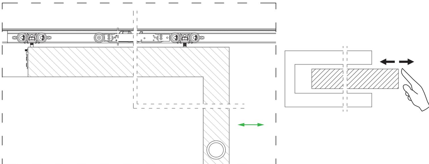
**8 Einzelflügel und Doppelflügel, Bremse hinten:** Befestigen Sie nun mit den Flachkopfschrauben, nachdem Sie den Türblatteinstand durch Verschieben der Metallzunge nach Ihren Wünschen eingestellt haben, die Metallzunge in ihrer Endposition.
