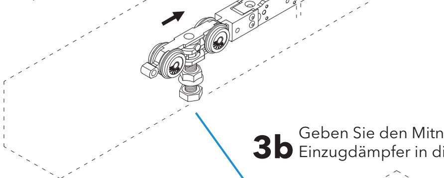
**3b** Geben Sie den Mitnehmer c für den Einzugsdämpfer in die Laufschiene.
