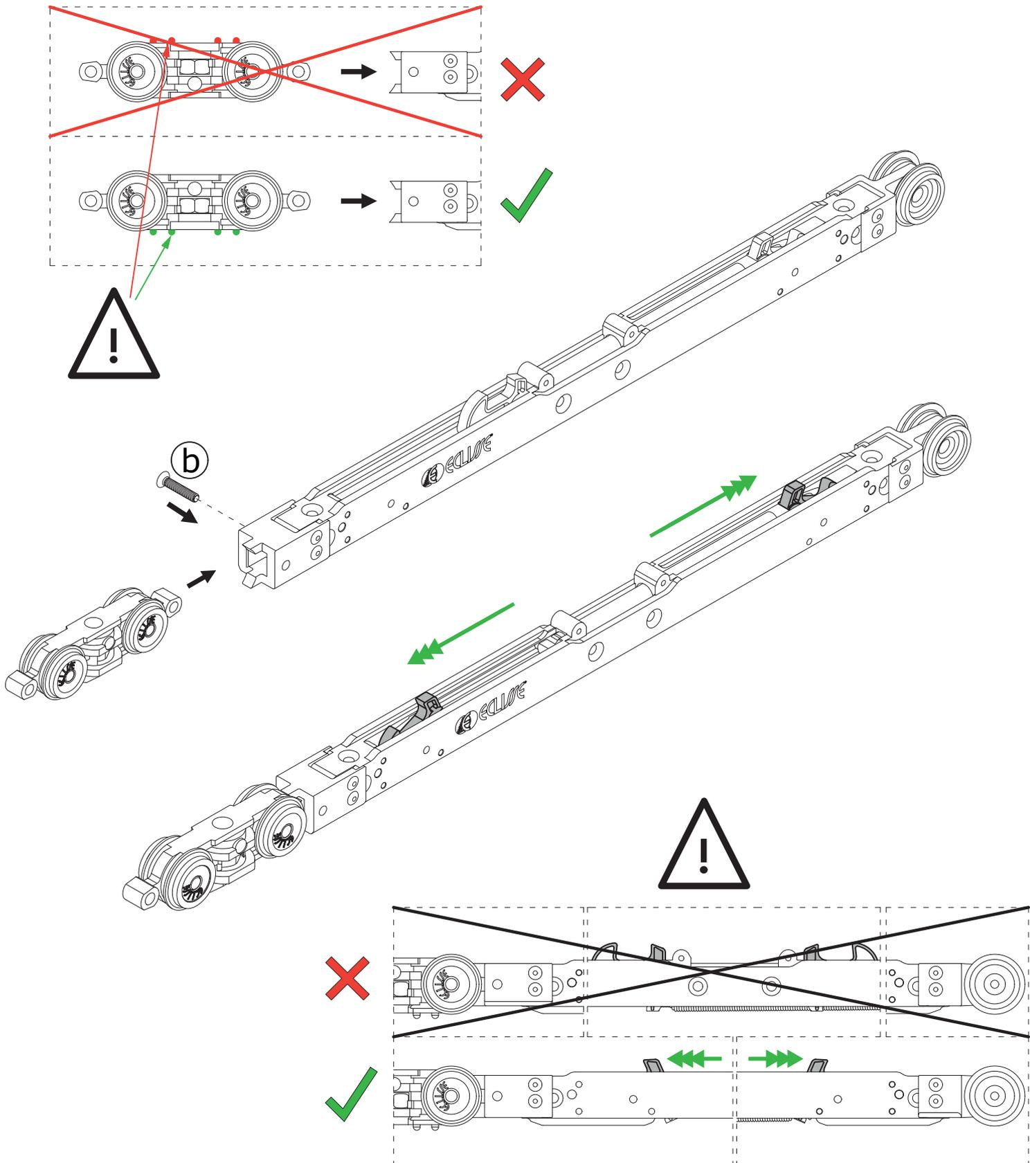
**3a** Geben Sie den hinteren Laufwagen wieder in die Laufschiene. Danach geben Sie den vorderen Laufwagen mit montiertem BIAS DS in die Laufschiene.
