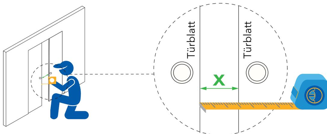
**8b** Verschieben Sie um genau die Hälfte dieses Maßes X die Mitnehmer C weiter zur Mitte und fixieren sie diese wieder. Fertig!
