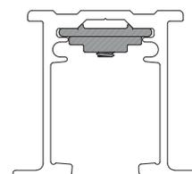
**4** Bauen Sie die Laufschiene wieder in den Schiebetürkasten ein. Durch das Langloch am Ende der Zunge können Sie durch Verschieben der Zunge alle Schrauben der Laufschiene wieder befestigen.
