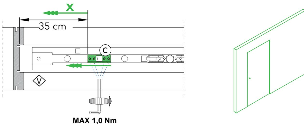
**6b Variante Doppelflügel:** Fixieren Sie die Mitnehmer C provisorisch mit 35 cm Abstand zu den mittigen Laufschienenenden. Schließen Sie danach die Türen soweit wie möglich, es wird ein Spalt bleiben.
