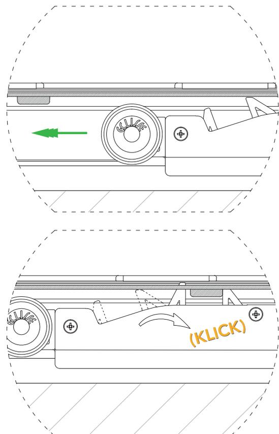
**7 Einzelflügel und Doppelflügel, Bremse hinten:** Schieben Sie nun das Türblatt in die gewünschte Endposition. **Je nach Modell und Griff ist entweder ein Kompletteinschub möglich oder es bleibt ein Türblatteinstand.**
