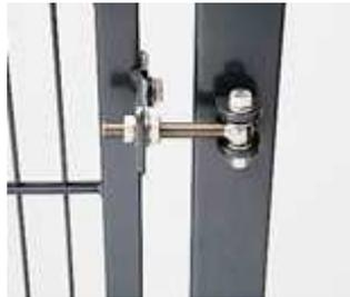
Achten Sie bei der Pfostenmontage darauf, dass die angebrachten Einnietmutter des Scharnierpfostens in die Richtung s. Bild1 der späteren 90° oder Bild2 der späteren 180° Öffnung zeigen. Zum Abschluss setzen Sie die Pfostenkappen (2) auf die Pfosten.
