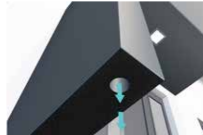
2. Dachdurchführung und Fallrohr im Seitenteil
