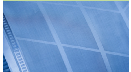
Trommeldesign: Bespannung 63 µ
