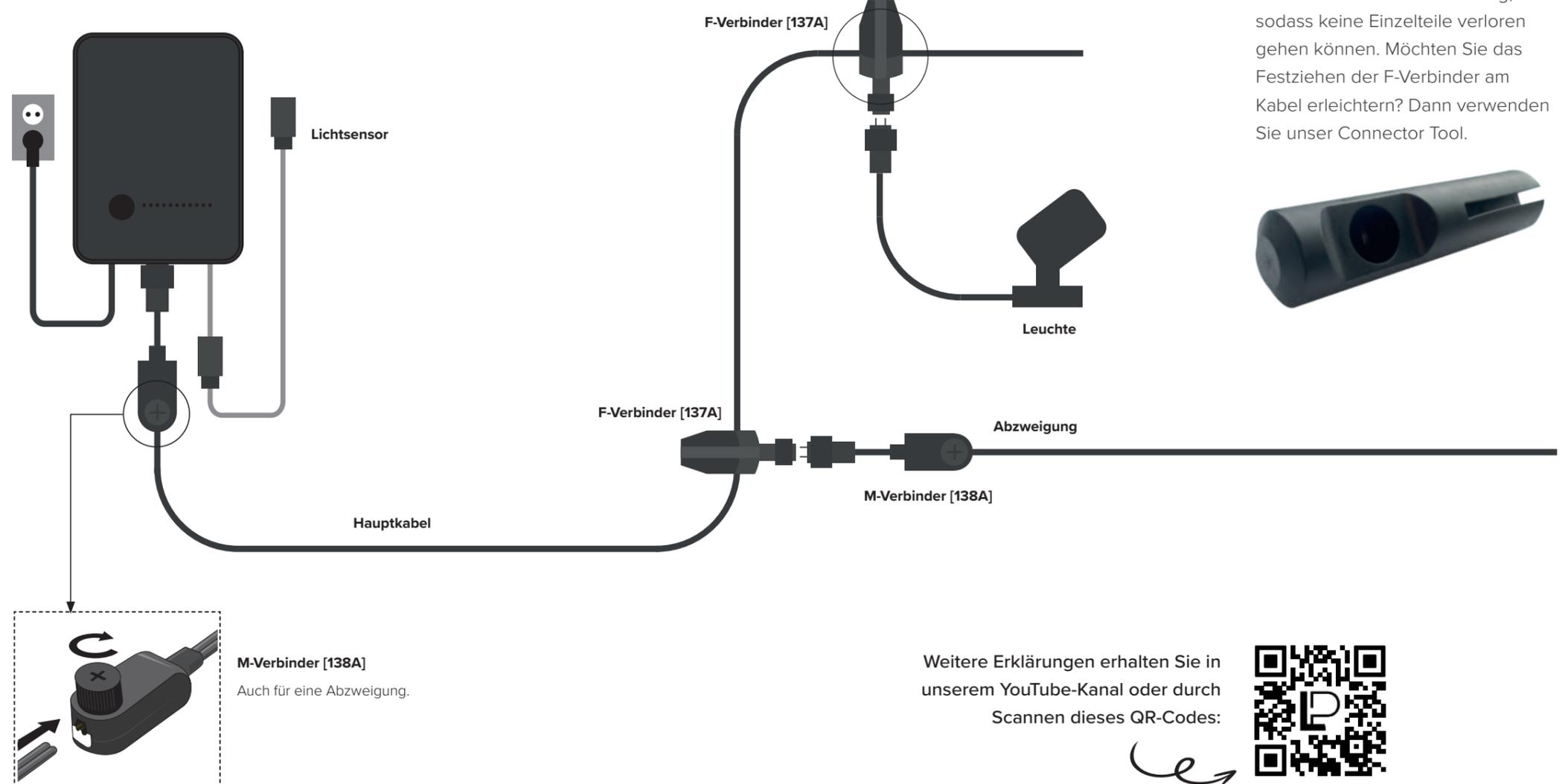
Unsere F-Verbinder ist einteilig, sodass keine Einzelteile verloren gehen können. Möchten Sie das Festziehen der F-Verbinder am Kabel erleichtern? Dann verwenden Sie unser Connector Tool.
