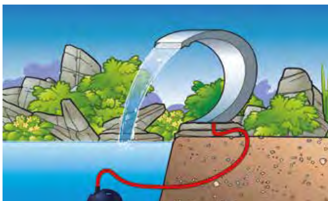
Installation des Wasserfalls am Teich
