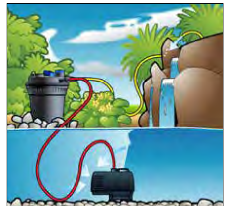
BioPressure®II speist einen Bachlauf mit Teichpumpe.
