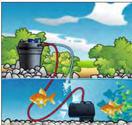
BioPressure®II mit Teichpumpe, neben dem Teich.
