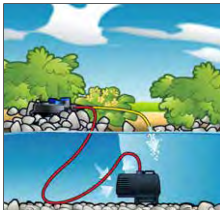
BioPressure®II neben dem Teich, eingegraben mit Teichpumpe.
