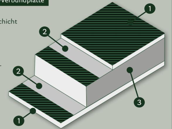
lität weisen die Alu-Verbund- platten außerdem eine hohe UV-Beständigkeit auf und halten Temperaturen von minus 50°C bis plus 80°C aus. Somit sind sie überall einsetzbar und äußerst witterungsbeständig. Daher verwenden wir das Material nicht nur bei Carportsystemen, sondern auch für den neuen Geräteraum, die Aluminium-Hochbeete und die neue Gartenbox.
