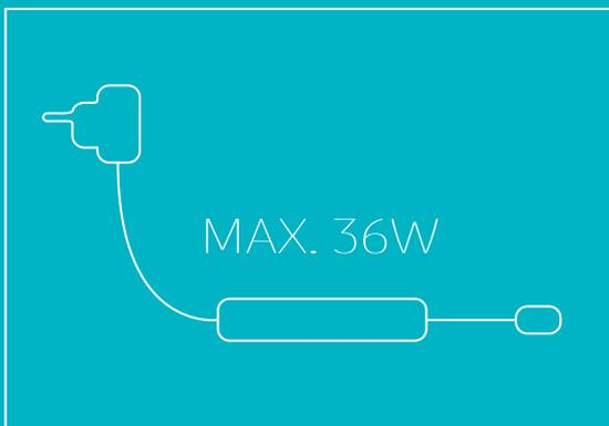
Netzteil hinzufügen (max. 36 W Leistungsaufnahme aller angeschlossenen Leuchten in Summe)
