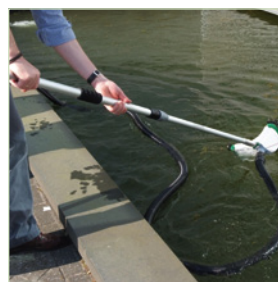
Gleichzeitig Reinigen und Absaugen mit Saugdüsenaufsatz
