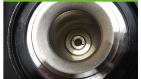
Edelstahlspaltrohr mit Keramiklager
