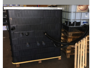
24h Dichtigkeitstest vor dem Versand
