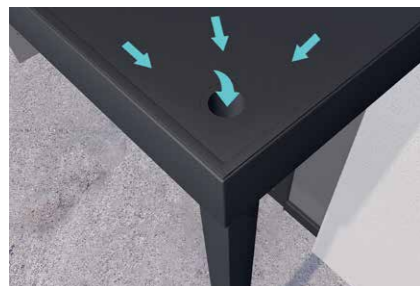
Dachdurchführung mit Wasserabführung im Pfosten
