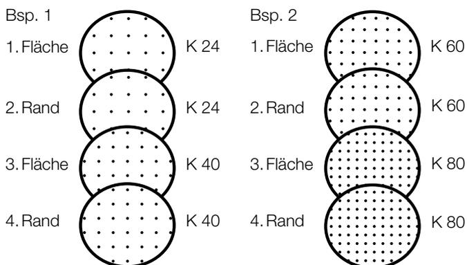
Beim Flächenschliff mit einer Einscheiben- oder einer Dreischeibenschleifmaschine immer die gleiche Körnung wie beim vorangegangenen Schleifgang mit der Randschleifmaschine verwenden.
