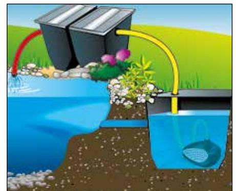
Pumpe Smartmax® Fi auch geeignet für einen Pumpenschacht.
