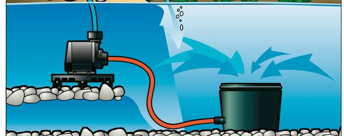
Unterwasserfilter BioPure® angeschlossen an den Saugstutzen der Pumpe, hier wird das gereinigte Wasser einfach über den Druckstutzen mit angeschlossenem Schlauch wieder dem Teich zugeführt.
