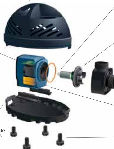
Die Schraubfüße garantieren eine perfekte Justierung und eine maximale Stabilität am Boden des Teiches;
