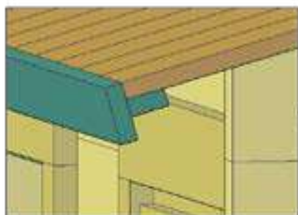
Befestigung mit 3,5x45 Schrauben
