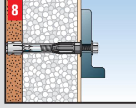
**7** (D) Anbauteil montieren, Schraube handfest anziehen.
