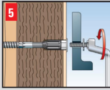
**5** (D) Anbauteil montieren, Schraube handfest anziehen.
