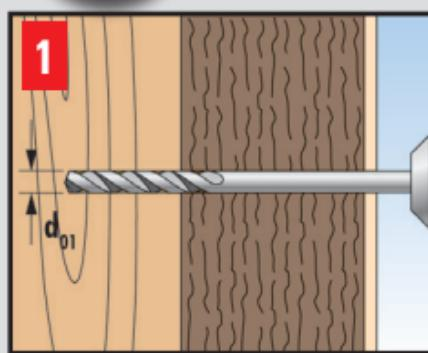
**1** (D) Bohren. **Thermax 8:**  $d_{01} = 6$  mm in Buche  $\geq D35$ ,  $d_{01} = 5$  mm in Fichte  $\geq C24$ , **Thermax 10:**  $d_{01} = 7$  mm in Buche  $\geq D35$  und Fichte  $\geq C24$ .
