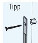
4. Das Schließblech kann später noch durch die Querslitze feinjustiert werden, sodass das Tor einwandfrei schließt.
