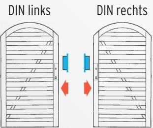
**Das Schloss ist für rechts und links anschlagende Tore verwendbar (DIN rechts oder DIN links).**
