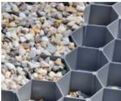
Die ACO Self® Kiesstabilisierung ist ein innovatives, recycelbares System zur Stabilisierung von Kies und Splitt. Mit ihrer sechseckigen Honigwabenstruktur aus recyceltem Polypropylen ist sie dafür ausgelegt, einen starken und stabilen Untergrund für das professionelle Ausbringen von Kies zu schaffen. Fachgerecht verlegt entsteht so eine stabile und 100% wasserdurchlässige Oberfläche, die bege- und befahrbar ist.
