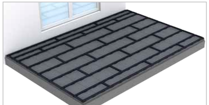
Verwindungssteifer Rahmen mit DREAMDECK ALU UK flach.
